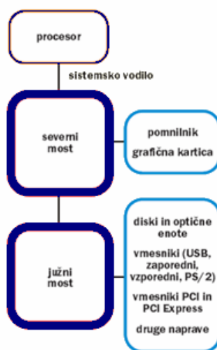
Slika 36: Shema priklopov naprav na severni in južni most
