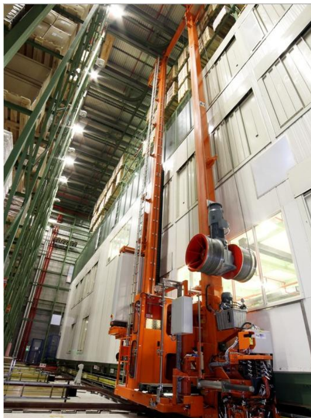
Slika 34: Avtomatizirano visokoregalno skladišče embalaže v Krki, d. d.
