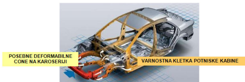
Slika 13: Konstrukcija moderne samonosne karoserije
