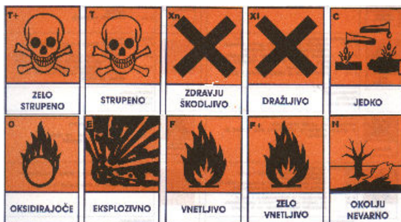
Slika 64: Črkovni in grafični simbol nevarne snovi po prilogi II direktive 67/548/EGS Vir: Direktiva 67/548/EGS in Direktiva 2001/59/ES
