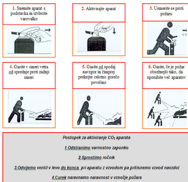
Slika 76: Navodilo za delo z gasilnikom na CO 2 Vir: http://www.najdi.si/gas.12 (12. 4. 1997)
