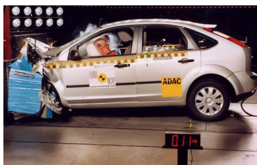
Slika 12: Deformacija karoserije po preizkusnem trku NCAP
