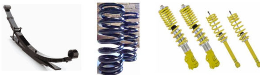
Slika 15: Listnate vzmeti, vijalne vzmeti in vzmeti z blažilniki
