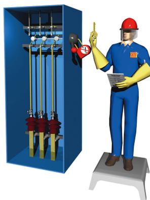
Slika 6: Preprečiti ponovno vklopitev (zavaruj, zakleni)
