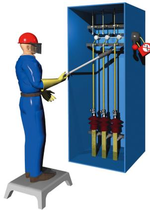
Slika 7: Ugotoviti breznepetostno stanje (uporabi indikator napetosti)
