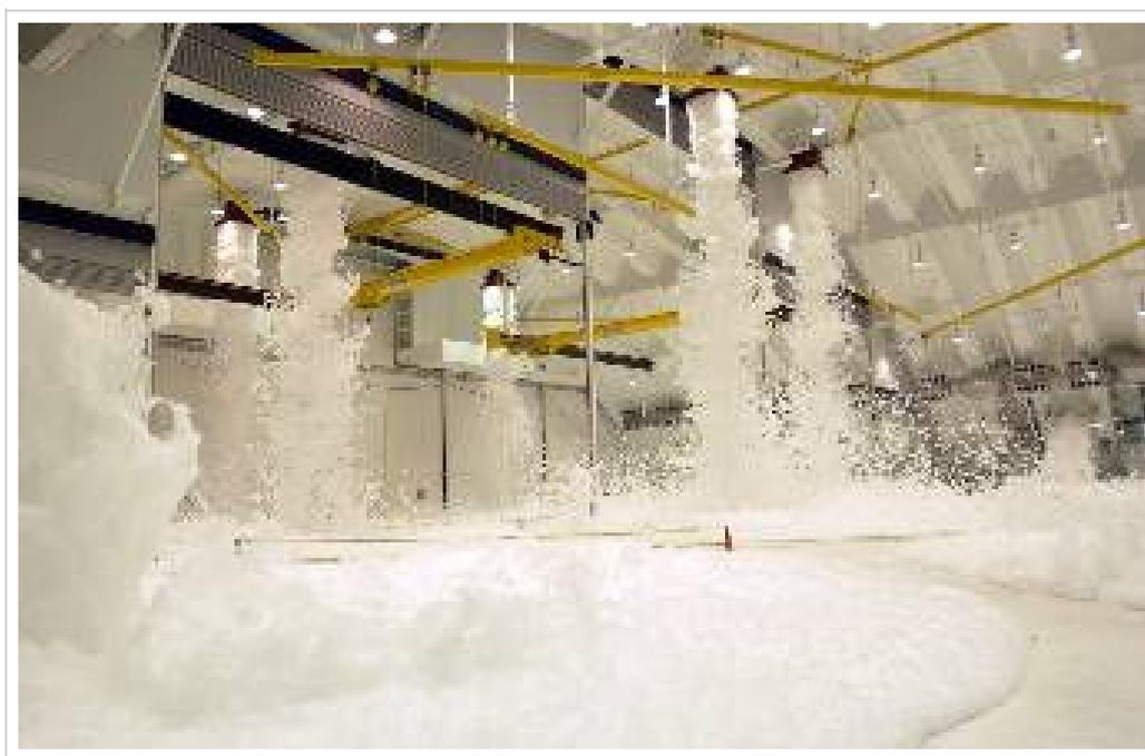
Slika 26: Testiranje gasilnega sistema s peno v letalskem hangarju
